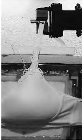
Abb. 3 u. 4 SWEATOR-System: Sweatorschale mit Prothese, 3) ohne Roboter und 4) mit Roboter.
